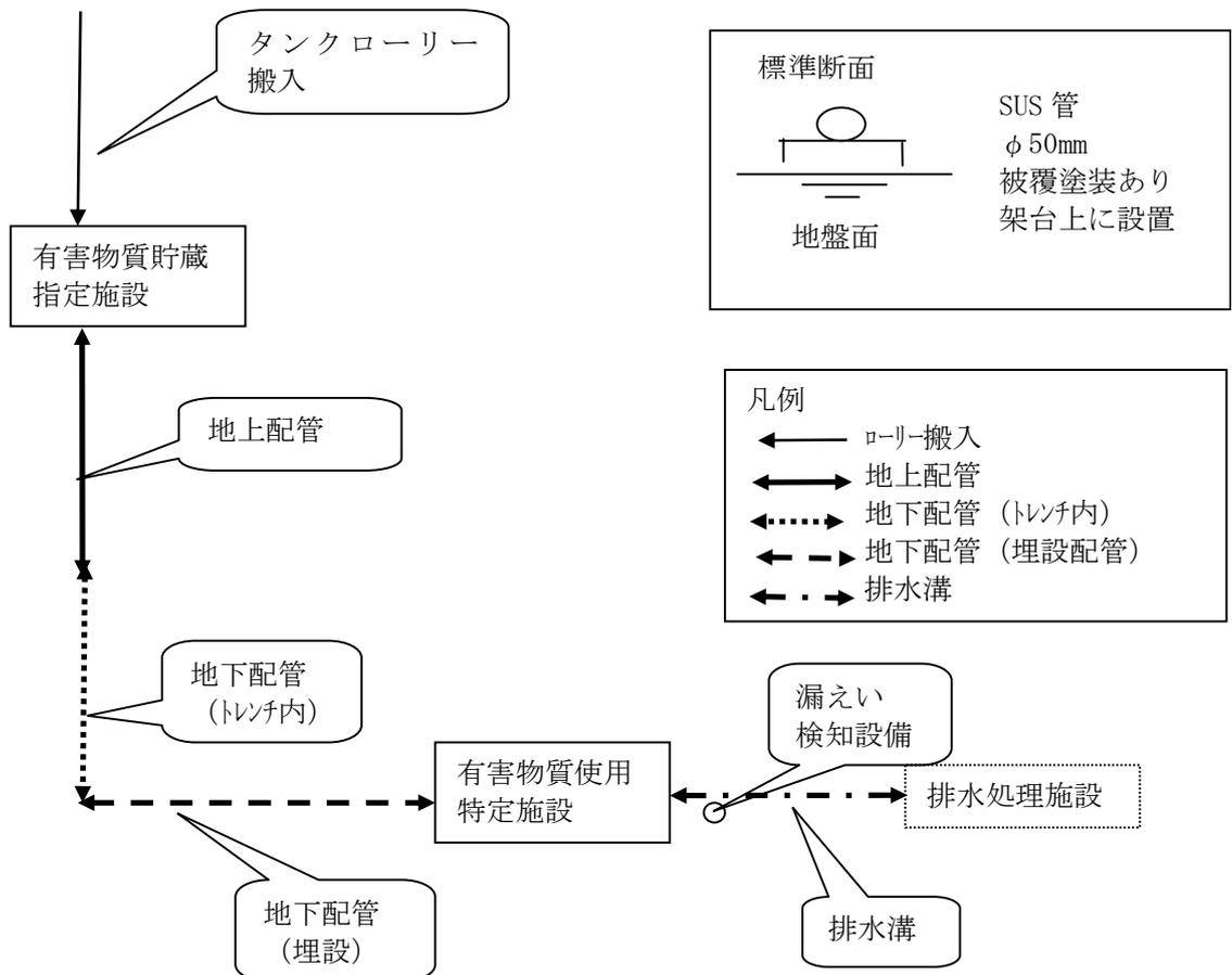
用水及び排水の系統（搬入及び搬出の系統）
