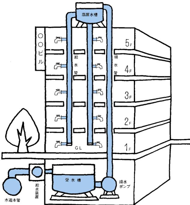
受水槽をもつ水道のうち、受水槽の容量が 10 m<sup>3</sup> を超えるものは、水道法で「簡易専用水道」とよばれ、①設置者が衛生的に管理すること、②定期に検査を受けること、が義務付けられています。
