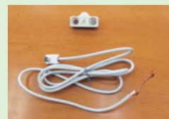
①市販の分配器(上)、コネクタ、同軸ケーブルを用意する
