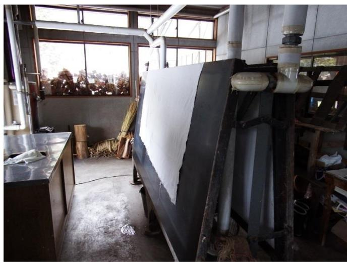
圧縮機により脱水した後、鉄板によって乾燥
