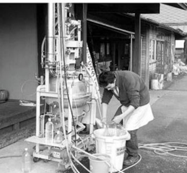
米からのエタノールの製造試験 (奥州市での研究)
