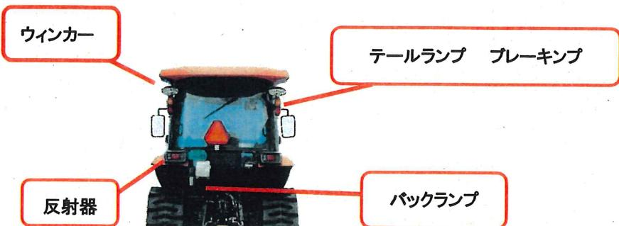
農作業機を装着しても、灯火器類(方向指示器、後部反射器、前照灯、車幅灯、尾灯、制動灯、後退灯)が他の交通から確認できることが必要です。
