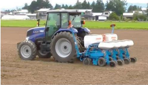
RTK-GPS自動操舵による大豆施肥・播種の高精度化
