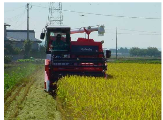
写真 汎用コンバインでの稲の収穫
