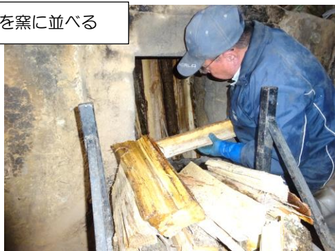
たき口。窯の煙が43° になったらたき口を閉じる
