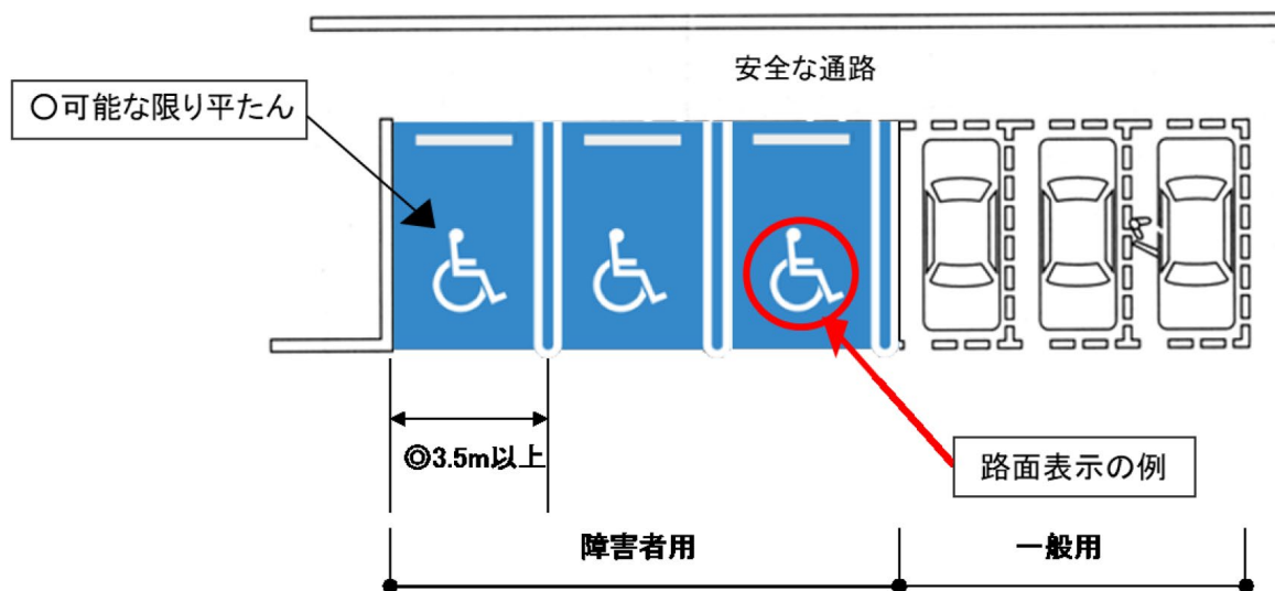
図 3-8 障がい者用駐車マスの構造の例
