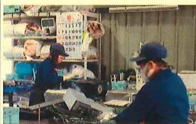
市町村ごとに回収した小型家電を手作業で選別・解体作業
