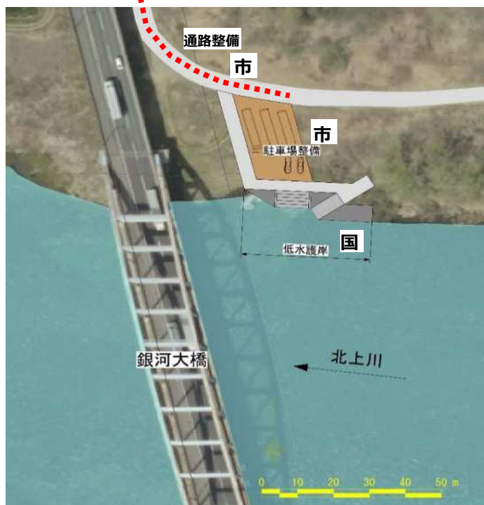
船着き場機能付きの低水護岸整備イメージ
